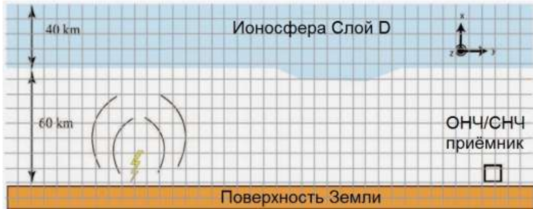
Рис. 2. Пример задания счетного объема в декартовой системе координат
